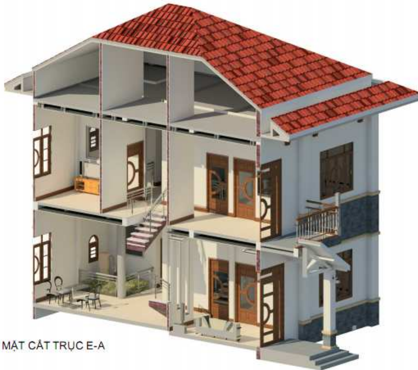
Hình 5.6. Thể hiện chi tiết mặt cắt trực quan từ mô hình BIM kiến trúc
